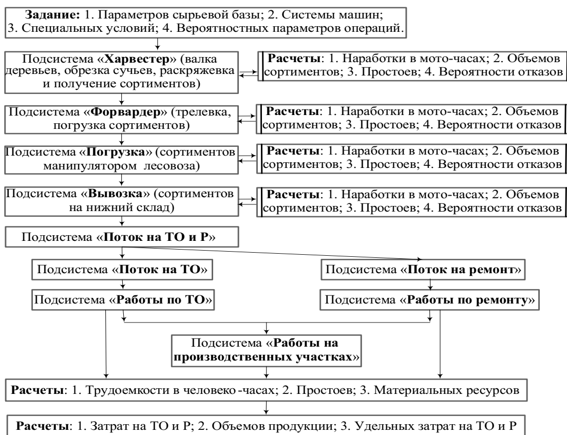
Рис. 1. Схема моделирования работ по ТО и Р с учетом производственной эксплуатации
