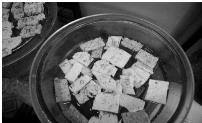
Рис. 2. Испытание образцов на водопоглощение
